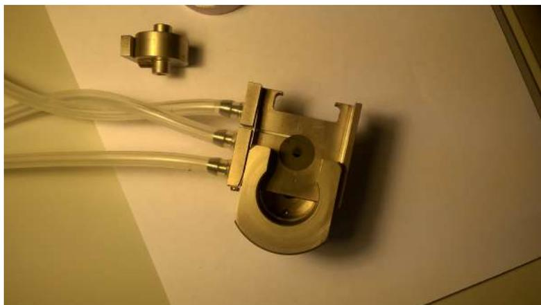
При этом контакт нужно задвинуть до упора, так, чтобы отверстия в графитовом контакте и матрице совпали:
