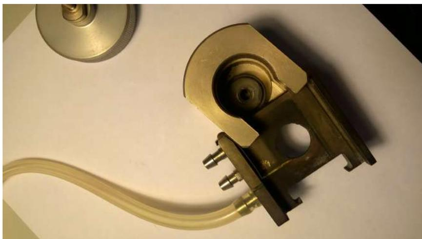
Сдуйте графитовую пыль с поверхности съемного металлического контакта и протрите эти поверхности тряпочкой, обильно смоченной этиловым спиртом. Теперь съемный металлический контакт готов к впрессовке нового графитового контакта.
