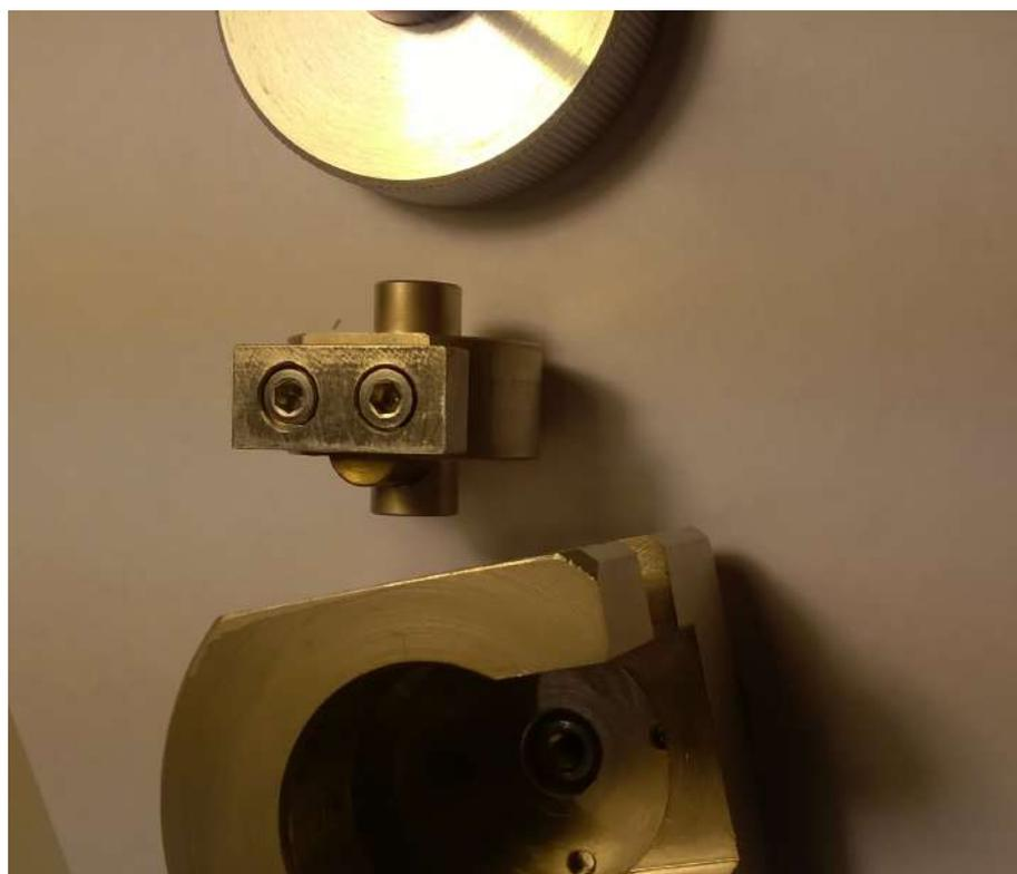
Снизу вверх: Матрица, пуансон и винт
