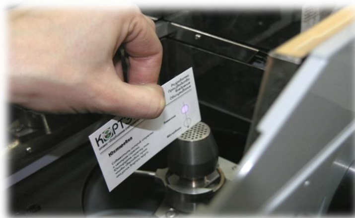
Рис. 61. Проверка положения эмиссионной горелки по юстировочной карточке
