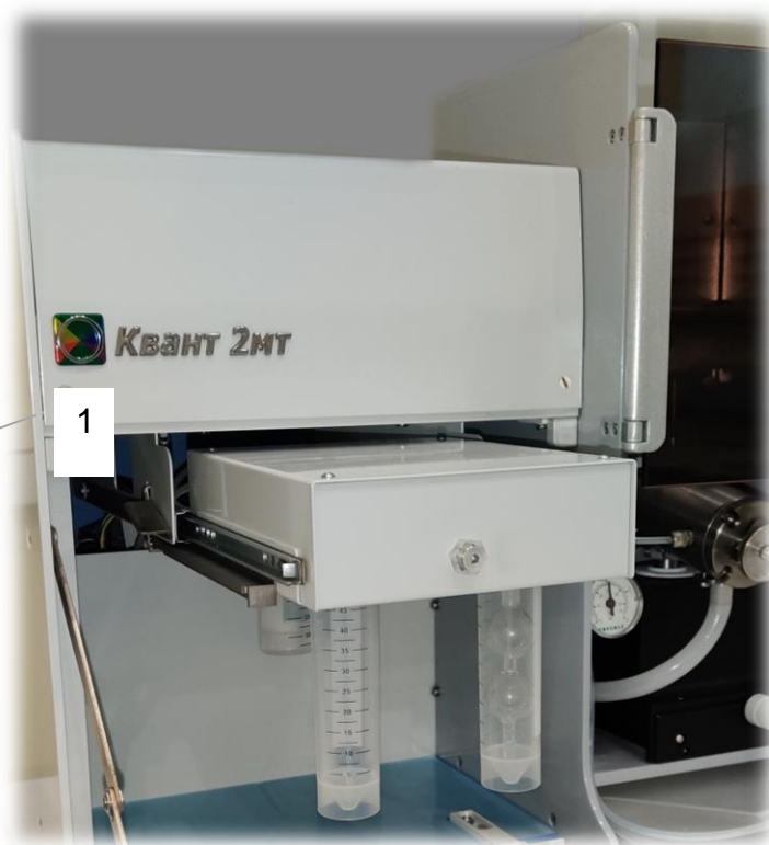
Рис. 66. Подключение трубки от кварцевой кюветы к приставке ГРГ, 1 - штуцер для подключения трубки от кюветы
