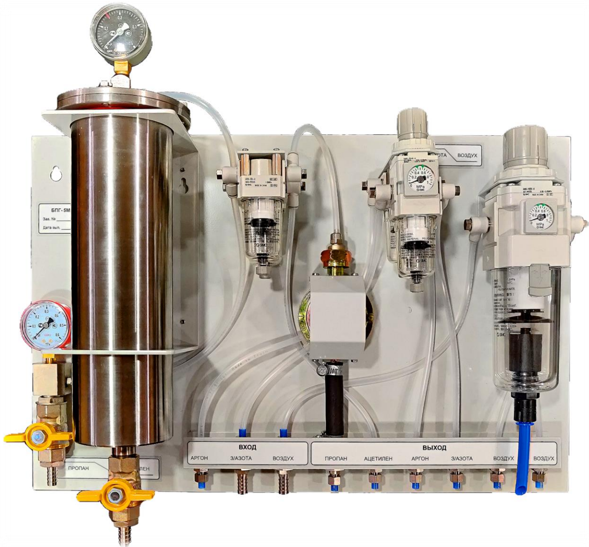
Рис. 27. Блок подготовки газов универсальный для подключения всех видов используемых газов
