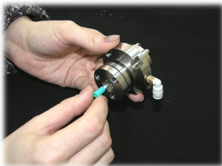
Рис. 74. Прочистка иглы распылителя с помощью приспособления
