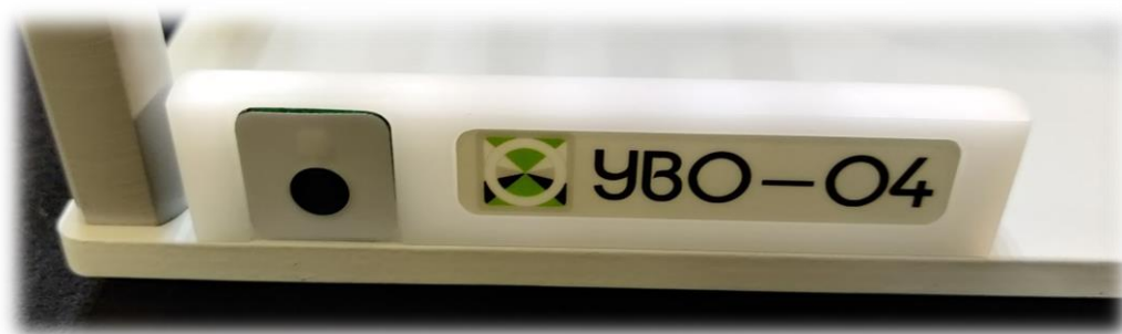
Рис. 2 Панель с кнопкой включения и индикации УВО - 04
