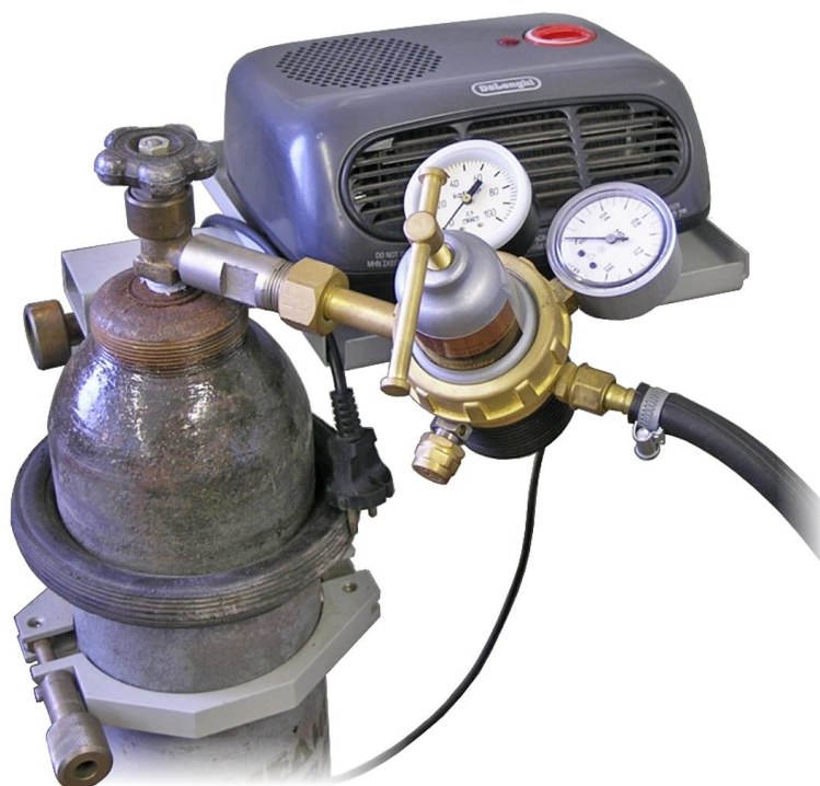
Рис.11. Подогрев редуктора с закисью азота
