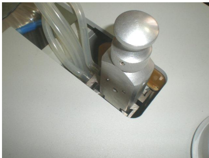
Рис. 9 – Установка сборки в направляющие стойки
